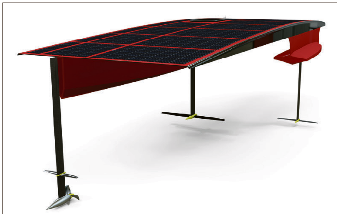
Un bateau basé sur un prao (pirogue indonésienne asymétrique) à panneaux solaires avec des foils (ailes d'avion sous l'eau) pour augmenter drastiquement l'efficacité.
